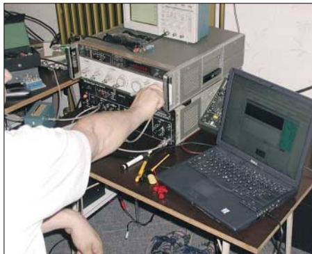
Bild 6: Die beiden Signalgeneratoren zur Messung des Großsignalverhaltens
