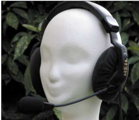
Bild 1: Heils Headset Pro Quiet mit HC4 Kapsel bewährt sich im Dauereinsatz bei DC9ZP: Bislang über 11 000 QSOs ohne Ausfall.
