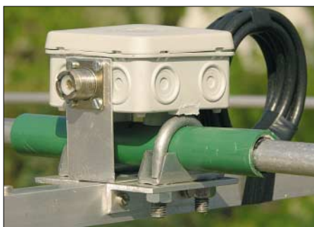
Bild 4: Strahlermittelstück mit aufgerollter Speisedrossel
