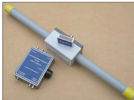
Bild 1: Power-Ferritmodul PFM-S/01 mit Anpassverstärker AAV SYM
