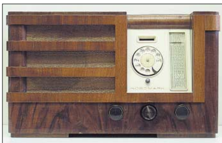
Aus der Stadt Kiel stammt dieser Empfänger der Firma Neufeldt & Kuhnke (heute Hagen): der Nordmark Wählscheiben-Super, ein Oktodensuper für Mittel- und Langwelle aus dem Jahr 1936. Die Abstimmung wurde mittels einer Telefonwählscheibe vorgenommen und jeder Sendefrequenz war eine zweistellige Zahl zugeordnet. Bei einem Preis von 236 Mark war der Empfänger für die Mehrheit der Radiohörer unerschwinglich.
