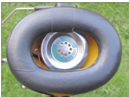
Bild 7: Die gute alte Postkapsel kommt in ungewohnter Umgebung zu neuen Ehren.
