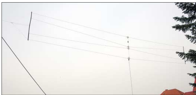
Bild 1: Die als Wideband Folded Loop bezeichnete Antenne hat die Form eines 7,5 m breiten Rechtecks.
