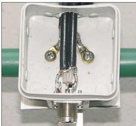
Bild 3: Strahlerdose mit angeschlossener Anpassleitung; zwischen den Lötösen liegt, hier verdeckt, ein Metalloxid-Schichtwiderstand 18 kΩ / 2 W zum Schutz vor statischen Aufladungen.
