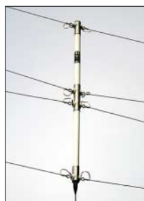
Bild 2: Im Mittelteil sorgt ein Übertrager für ein niedriges SWR im gesamten Arbeitsbereich. Vor der Antennenbuchse (SO 239) verhindert eine integrierte Mantelwellensperre HF auf dem Antennenkabel.
